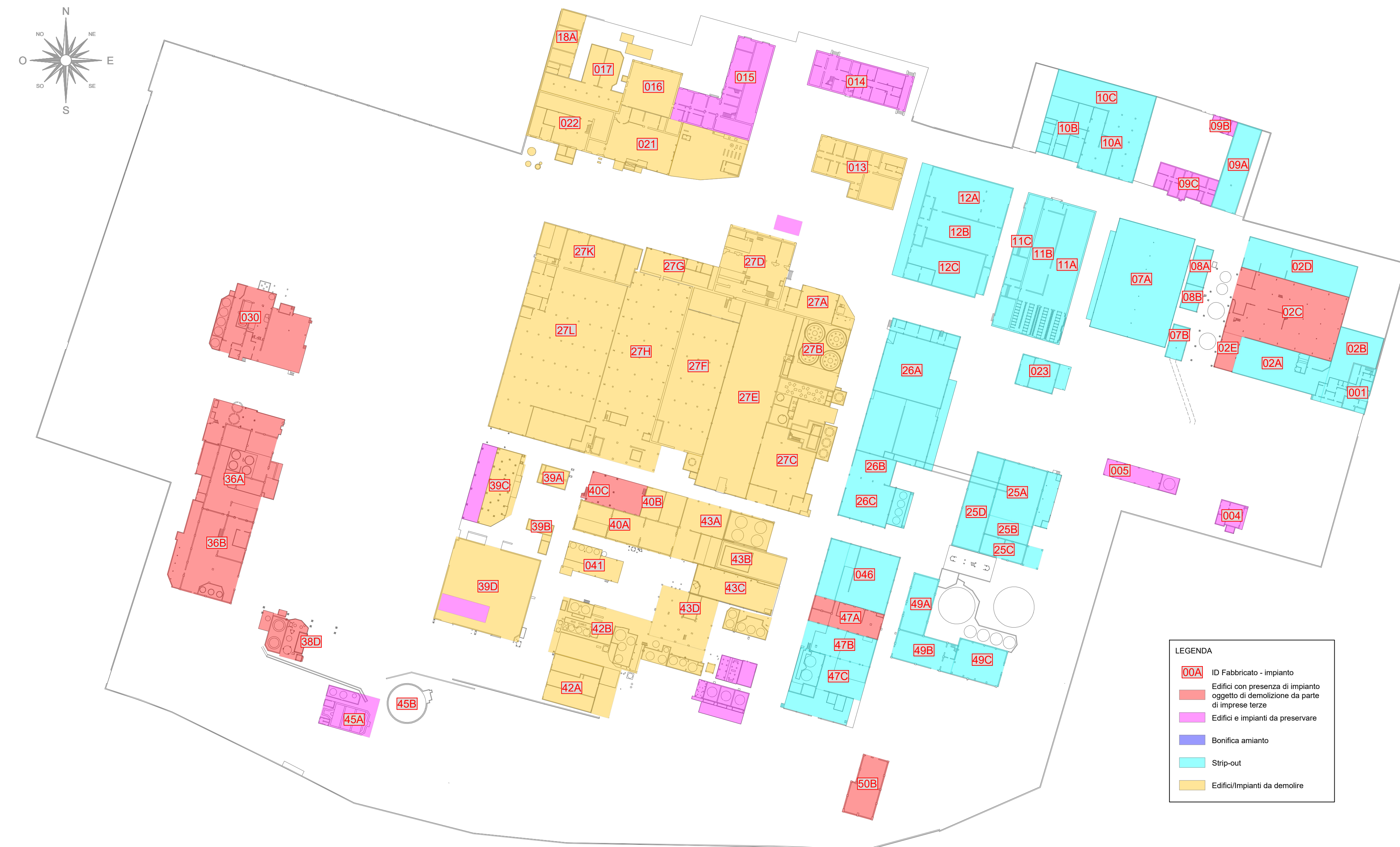
FASE E: Proseguimento strip-out degli edifici di Fase 4 del progetto definitivo (ove presente) e continuo demolizione degli edifici di Fase 3 del progetto definitivo - 1:1000
